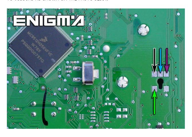
TO POWER UP DASH, WE MUST SOLDER POSITIVE (+) & NEGATIVE (-) LIKE ON PHOTOS BELOW:
