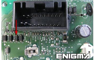
USE CABLE C11, REMOVE BACK PLASTIC COVER FROM DASH, THEN ON THE MAIN BOARD, SOLDER POWER CABLES:
