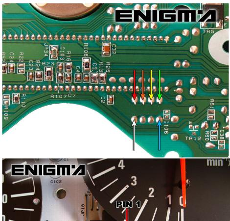
USE C7 CABLE, WE ONLY NEED TO TAKE OFF BACK PART OF DASH, LOCATE POINTS IN THE MAIN BOARD LIKE IN PHOTO BELOW AND SOLDER CABLE LEADS AS IT SHOWS TO US. NEVER TOUCH NAILS, IT IS VERY DANGEROUS.
