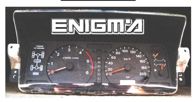
USE C7 CABLE, WE ONLY NEED REMOVE BACK PLASTIC COVER OF DASH, LOCATE POINTS IN THE MAIN BOARD LIKE IN PHOTO BELOW AND SOLDER CABLE LEADS AS IT SHOWS TO US. NEVER TOUCH NAILS, IT IS VERY DANGEROUS. MEMORY INSIDE THESE KIND OF CARS ARE A 93C46:
