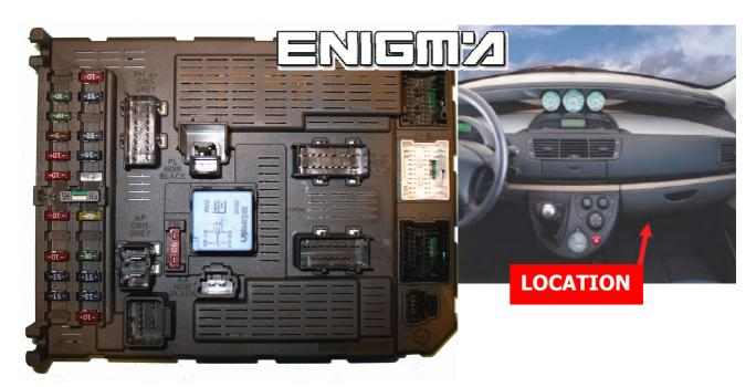
USE CABLE C12 O HCS12, TAKE OFF BACK SIDE FROM BSI, THEN CONNECT OR SOLDER CABLE LEADS ACCORDING TO COLOURS AS SHOWN OF BELOW PHOTO:
