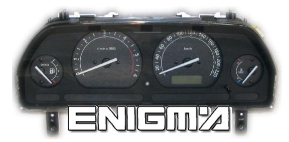
USE CABLE C45 + A6 ADAPTER, REMOVE BACK PLASTIC COVER FROM DASH.
