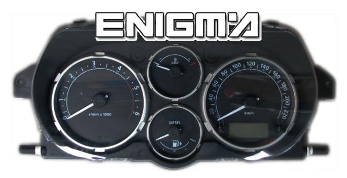
USE CABLE C45 + A6 ADAPTER, REMOVE BACK PLASTIC COVER FROM DASH.
