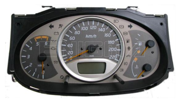
USE C7 CABLE, WE ONLY NEED TO TAKE OFF BACK PART OF DASH, LOCATE POINTS IN THE MAIN BOARD LIKE IN PHOTO BELOW AND SOLDER CABLE LEADS AS IT SHOWS TO US. NEVER TOUCH NAILS, IT IS VERY DANGEROUS. MEMORY INSIDE THIS KIND OF CARS IS A 93C56 (S221).
