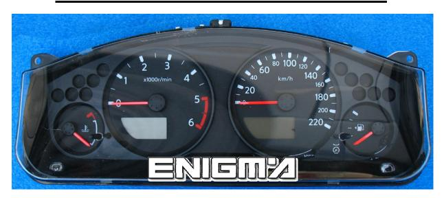
USE CABLE C12, REMOVE BACK PLASTIC COVER FROM DASH, THEN CONNECT OR SOLDER CABLE LEADS ACCORDING TO COLOURS AS SHOWN OF BELOW PHOTOS:
