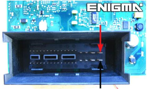
NOW LOCATE POINTS ON THE OTHER SIDE OF BOARD LIKE IN PHOTO BELOW AND SOLDER CABLE LEADS AS IT SHOWS TO US:
