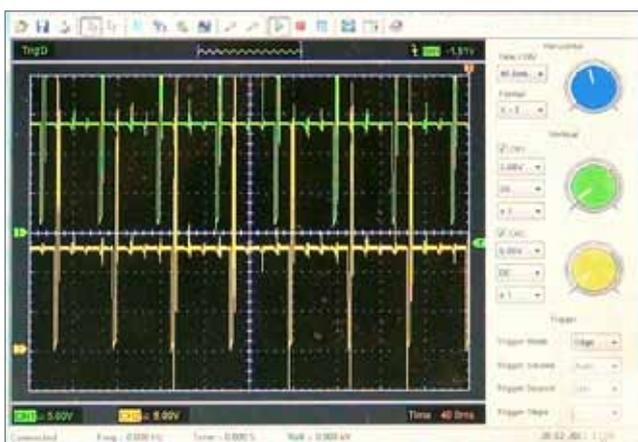
Si se acelera el motor, los pulsos aumentan de frecuencia (se "acercan" entre sí), y al regresar a la posición en reposo, la señal recupera su frecuencia original.
