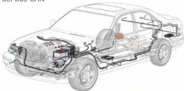
Precisamente, para solucionar este inconveniente, se estableció una comunicación de tipo bus, con la cual se tiene únicamente un par de cables llegando hasta todos los circuitos que requieran enviar o recibir información desde la computadora. Y a través de estos cables se distribuyen las instrucciones para todos los periféricos asociados. Físicamente, un auto con bus CAN (o CAN-Bus, como también se le conoce), tendría un cableado como el que se muestra en la figura 5.3.
