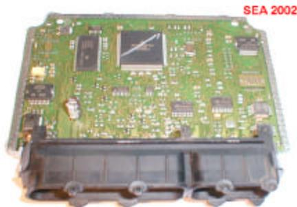
Aprire la centralina facendo attenzione durante la rimozione del coperchio a non fare leva con qualsiasi utensile per non danneggiare internamente i componenti elettronici.
