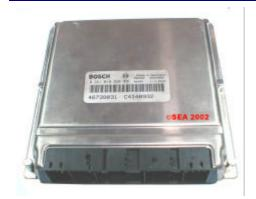
Aprire la centralina rimuovendo le 6 viti di fissaggio poste ai lati.
