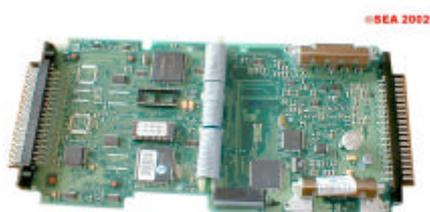
Disaccoppiare le due schede rimuovendo il fermo a "pettine" posto nella parte superiore del connettore facendo leva sui ganci posti nella parte laterale del connettore.
