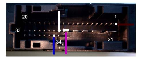
CAS PIN 25 - ENIGMA DB25 PIN 03GNDCAS PIN 35 - ENIGMA DB25 PIN 08CANCAS PIN 26 - ENIGMA DB25 PIN 21CANCAS PIN 01 - ENIGMA DB25 PIN 25+12V
