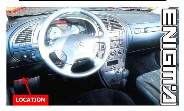
USE CABLE C7, TAKE OFF BACK SIDE FROM BSI, THEN CONNECT OR SOLDER CABLE LEADS ACCORDING TO PIN AS SHOWN OF BELOW PHOTO:
