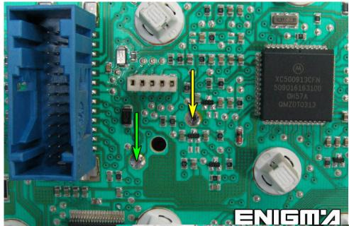
USE CABLE C12, REMOVE BACK PLASTIC COVER FROM DASH, SOLDER CABLE LEADS ACCORDING TO COLOURS AS SHOWN OF BELOW PHOTOS:
