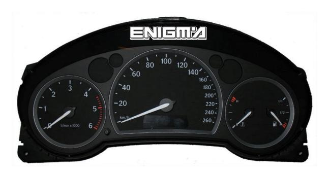
USE CABLE C12 O HCS12, TAKE OFF BACK SIDE FROM DASH, THEN CONNECT OR SOLDER CABLE LEADS ACCORDING TO COLOURS AS SHOWN OF BELOW PHOTO:
