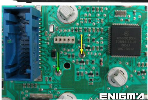
USE CABLE C11, REMOVE BACK PLASTIC COVER FROM DASH, SOLDER CABLE LEADS ACCORDING TO COLOURS AS SHOWN OF BELOW PHOTOS:
