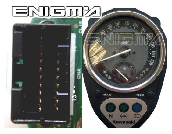
USE CABLE **C7**, OPEN BACK COVER FROM DASH, LOCATE POINTS SHOWN OF BELOW PHOTO, AND THEN SOLDER CABLE LEADS CONCORDANCE WITH ITS COLOUR:
