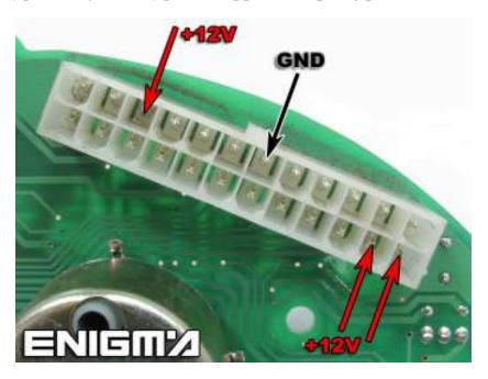
USE CABLE C4, REMOVE DASH'S BACK PLASTIC COVER, MAKE ONE BRIDGE:
