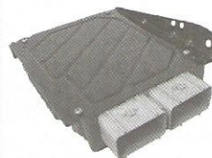
11 PCM Ubicada a un costado del radiador
