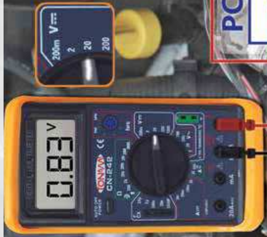
Comprobación de la señal del sensor MAF
