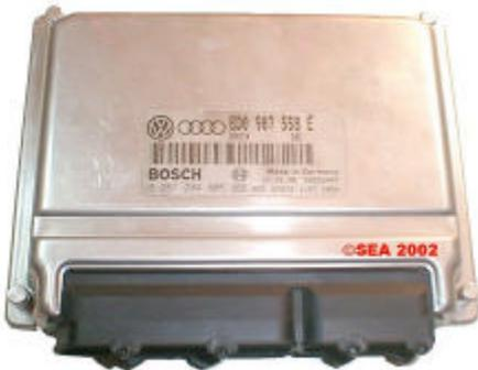
Aprire la centralina rimuovendo il coperchio tramite le 4 viti poste nella parte inferiore.
