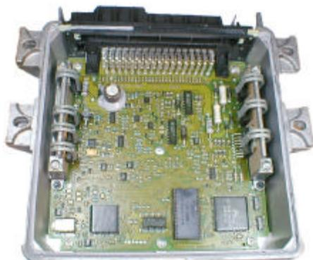
Sostituire L'eprom originale con quella fornita in allegato.
